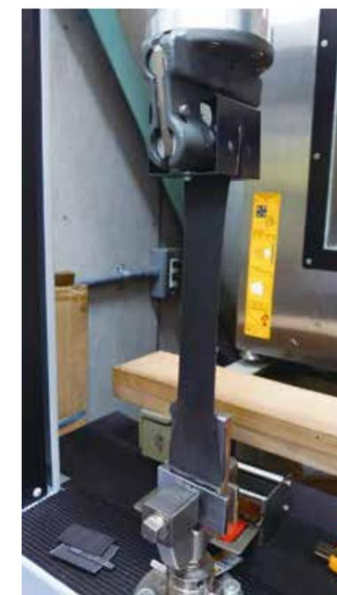
サンエーボンド PU + 鉄部引張強度試験
